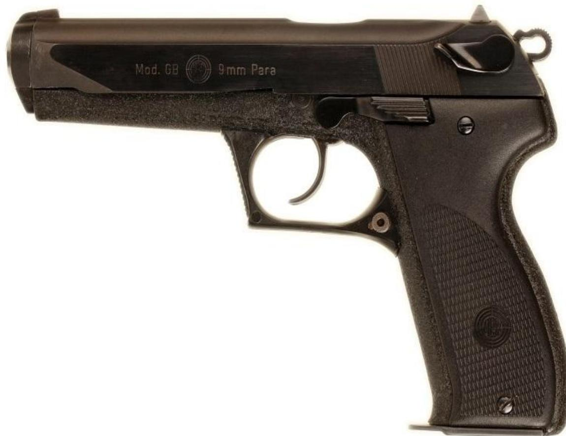
La Steyr GB, es una pistola semiautomática calibre 9x19mm Parabellum de doble acción. Emplea un sistema de acción de retroceso producido por gas y tiene una capacidad de 18 proyectiles. Fue diseñada en 1968 como un reemplazo para las armas de fuego del ejército austriaco. Entró en producción civil en 1982, aunque aproximadamente 2.300 copias fueron hechas a finales de 1970 en Morton Grove, Illinois por LES Incorporated, y comercializado como Rogak P-18.
