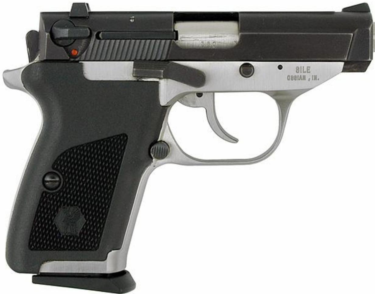
**Especificaciones:****Origen:** Suiza**Fabricante:** Sphinx**Acerrojamiento:** Sistema de retroceso directo**Calibre:** .380 ACP (9 mm Browning Corto)**Capacidad:** 10 proyectiles**Seguros:** Seguro externo: fiador del seguro en el lado izquierdo de la corredera. Seguro interno: el gatillo se desmonta después de cada disparo**Peso:** 710 gr**Longitud del cañón:** 85 mm**Largo:** 155 mm**Alto:** 117 mm**Miras:** Fijas, de 3 puntos
